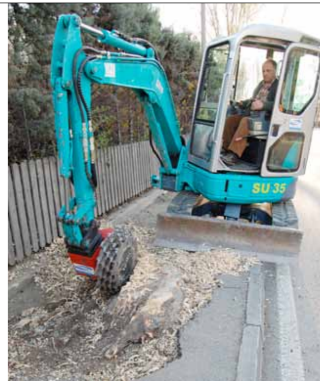
Hier rückt Albin Troger mit der Stockfräse einem Ahornstock zu Leibe, der einen Durchmesser von rund 1,8 Meter hat.
