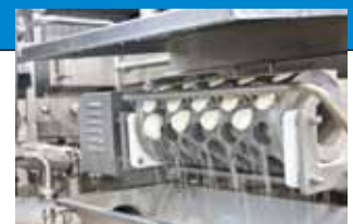
Das Ausformen der filierten Käsemasse erfolgt mit speziellen Aluminiumwalzen.
