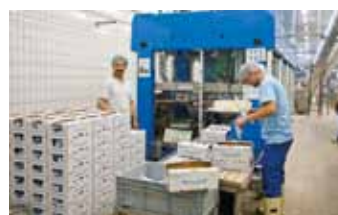
Das Füllen der Kartone erfolgt automatisch, die Kartone werden noch kontrolliert und auf Paletten geschichtet
